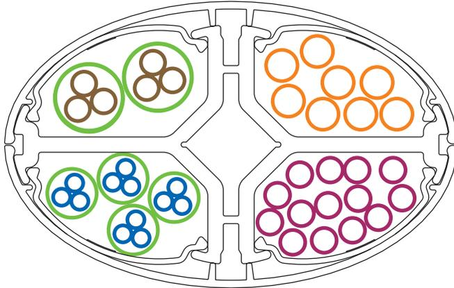
**Sección útil por compartimento = 558 mm<sup>2</sup>**
