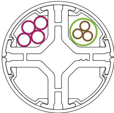
**Sección útil por compartimento = 177 mm<sup>2</sup>**
