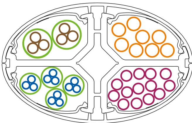
**Sección útil por compartimento = 558 mm<sup>2</sup>**
