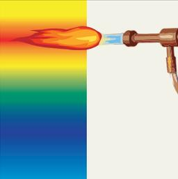
La baja conductividad térmica de los materiales aislantes evitan la generación de puntos calientes alejados del foco del incendio.
