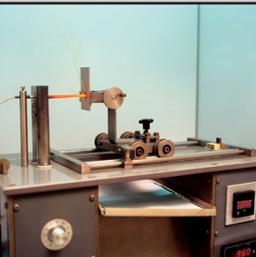
Las canales Unex superan el ensayo al máximo grado indicado en la norma: **960°C**
