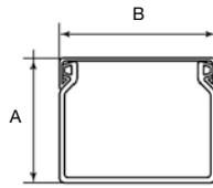
Compatible avec la norme EN 50085-2-3 et avec les normes qui se substituent à la DIN 43659 et à la NF C68-102
